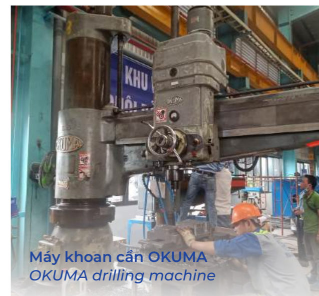
Máy khoan cần OOYA OOYA drilling machine
