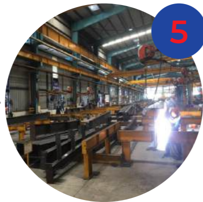
5 HÀN HOÀN THIỆN Finishing welding
