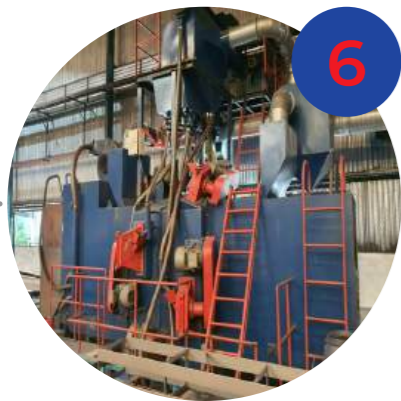
6 PHUN BI & VỆ SINH Shot blasting
