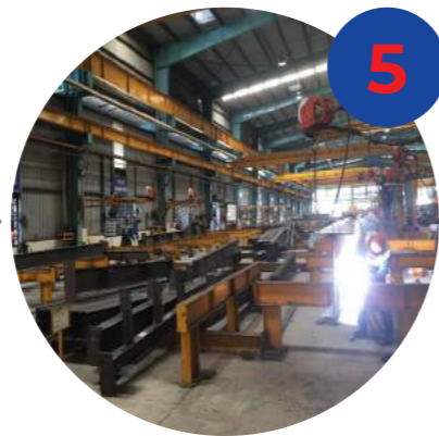
5 HÀN HOÀN THIỆN Finishing welding
